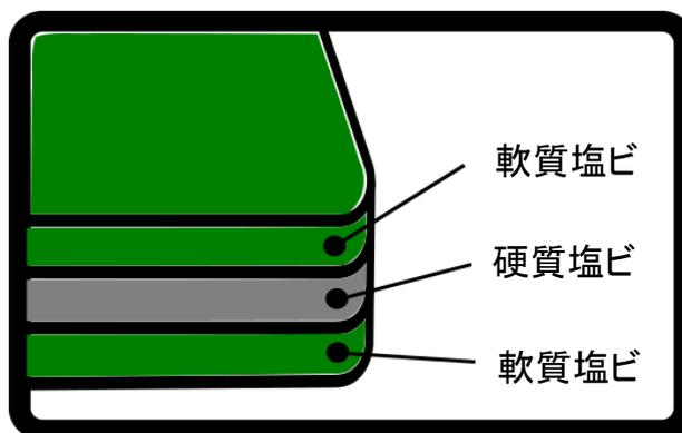
表面素材の軟質塩化ビニール2層で、芯材である硬質塩化ビニールを挟んで貼り合わせるにより、反りが起こらない構造になっています。また、平滑性が向上し、両面を使用することも同時に可能になりました。今では常識となっているカッティングマットの3層構造ですが、他社に先駆けて1980年に当社が研究開発、商品化に成功。国際特許を取得しました。
